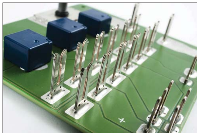
Ein verbauter dLAM-Lamellenkontakt in zweifacher Paketierung (Stromtragfähigkeit: 40 A).
