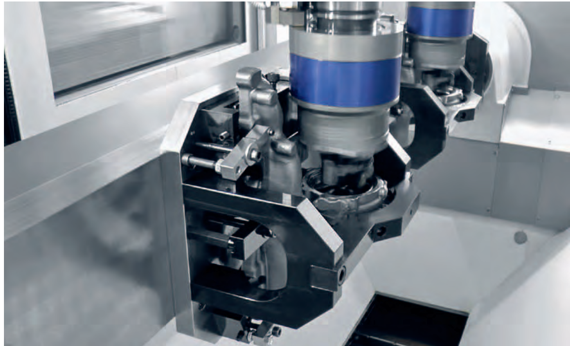
Hochpräzise und -produktive Turboladerbearbeitung in Kooperation mit der Komet Group auf dem Hochleistungs-Fräs-Dreh-Zentrum MT 838 TWIN
