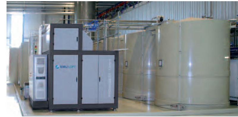
Die Verdampfer-Technologie reinigt Prozessabwässer so, dass bis zu 98 % wiederverwertbares Destillat entsteht.
