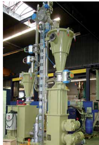
Ein Beispiel zur ENTEX-Neuentwicklung: Vakuumtrocknung TPU
