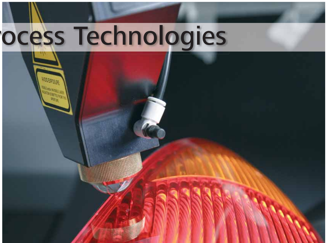
Mit dem GLOBO-Schweisskonzept werden mittels Laser z.B. Automobil-Rückleuchten verbunden.
