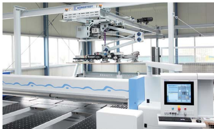
Flächenlager Optimat TLF 210 mit Horizontalsäge
