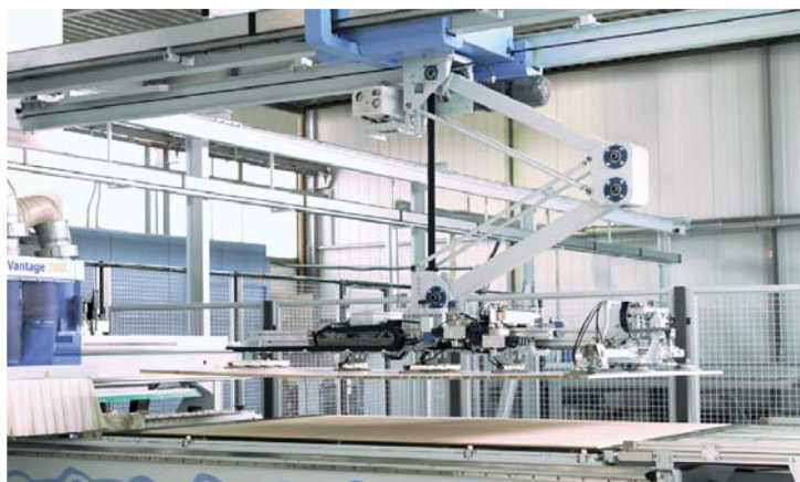
Flächenlager Profi TLF 210 mit CNC-Bearbeitungszentrum
